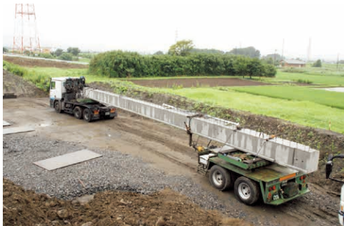
ポールトレーラー (No.3) TP182TS×2輛 積載量: 18.00t
